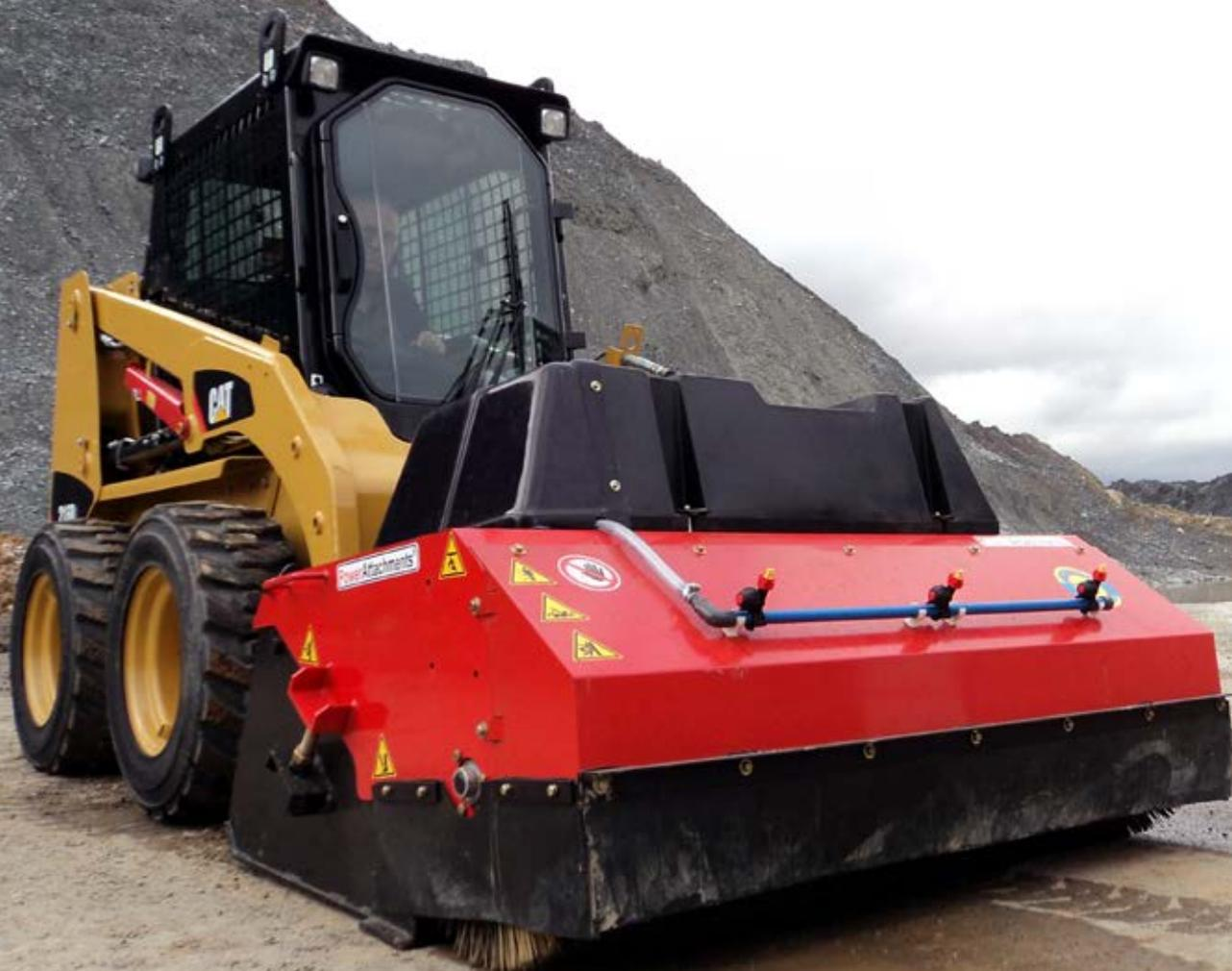
La barredora cucharón es un implemento diseñado para el barrido, limpieza y esparcido en la construcción, obra pública, recolección de material fresado en el mantenimiento y conservación de carreteras y limpieza y manutención de ganaderías y explotaciones agrícolas.
