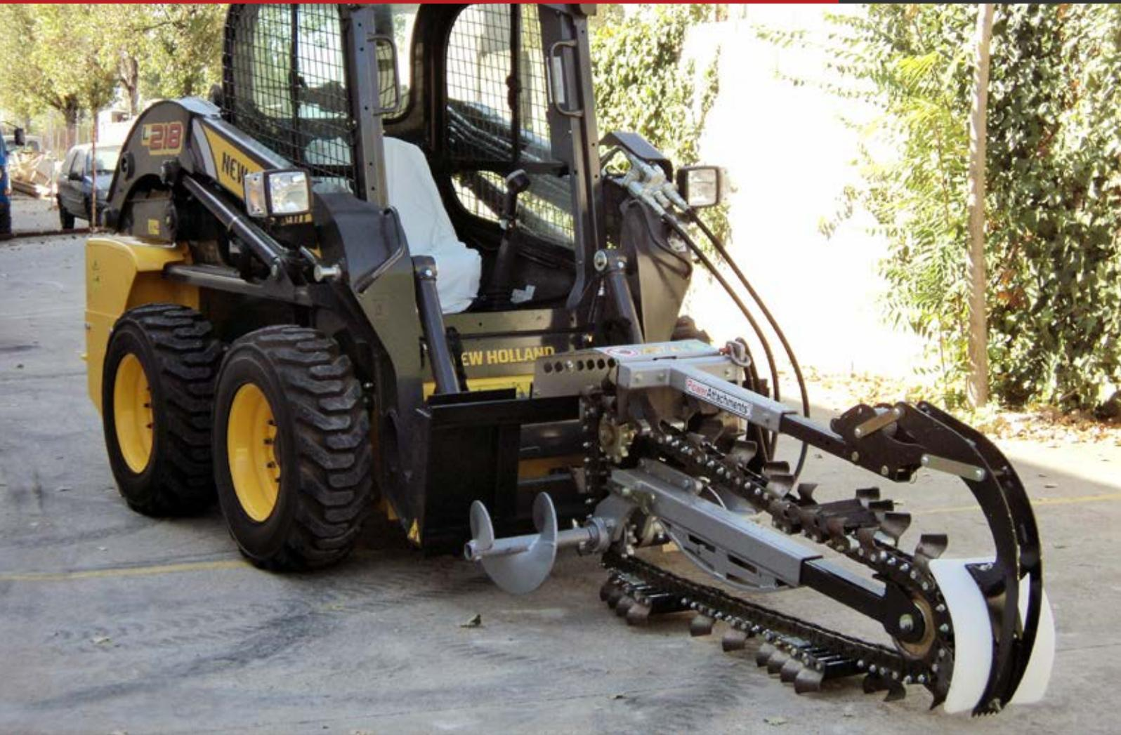
Zanjadoras de alto rendimiento con diferentes tipos de cadena, para la apertura de zanjas en la instalación de servicios en todo tipo de terrenos: vegetales, mixtos, compactos, incluso muy duros o con raíces.
