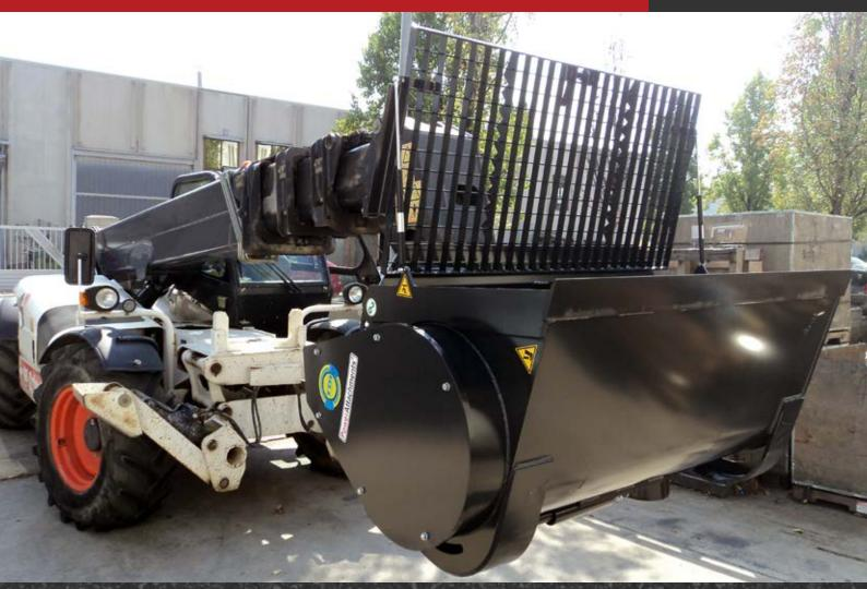
Cucharones hormigoneras indicados para mezclar hormigón y cemento de manera rápida y homogénea, además podrá transportalo y verterlo de manera fácil y cómoda, para cualquier tipo trabajo e industria dónde se necesite la producción de hormigón y cemento.
