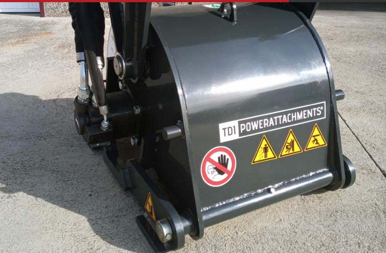
Fresadora de caudal estándar, proyectada para el fresado de asfalto y hormigón en la construcción y mantenimiento de carreteras, calles, naves industriales, accesos viales, etc.
