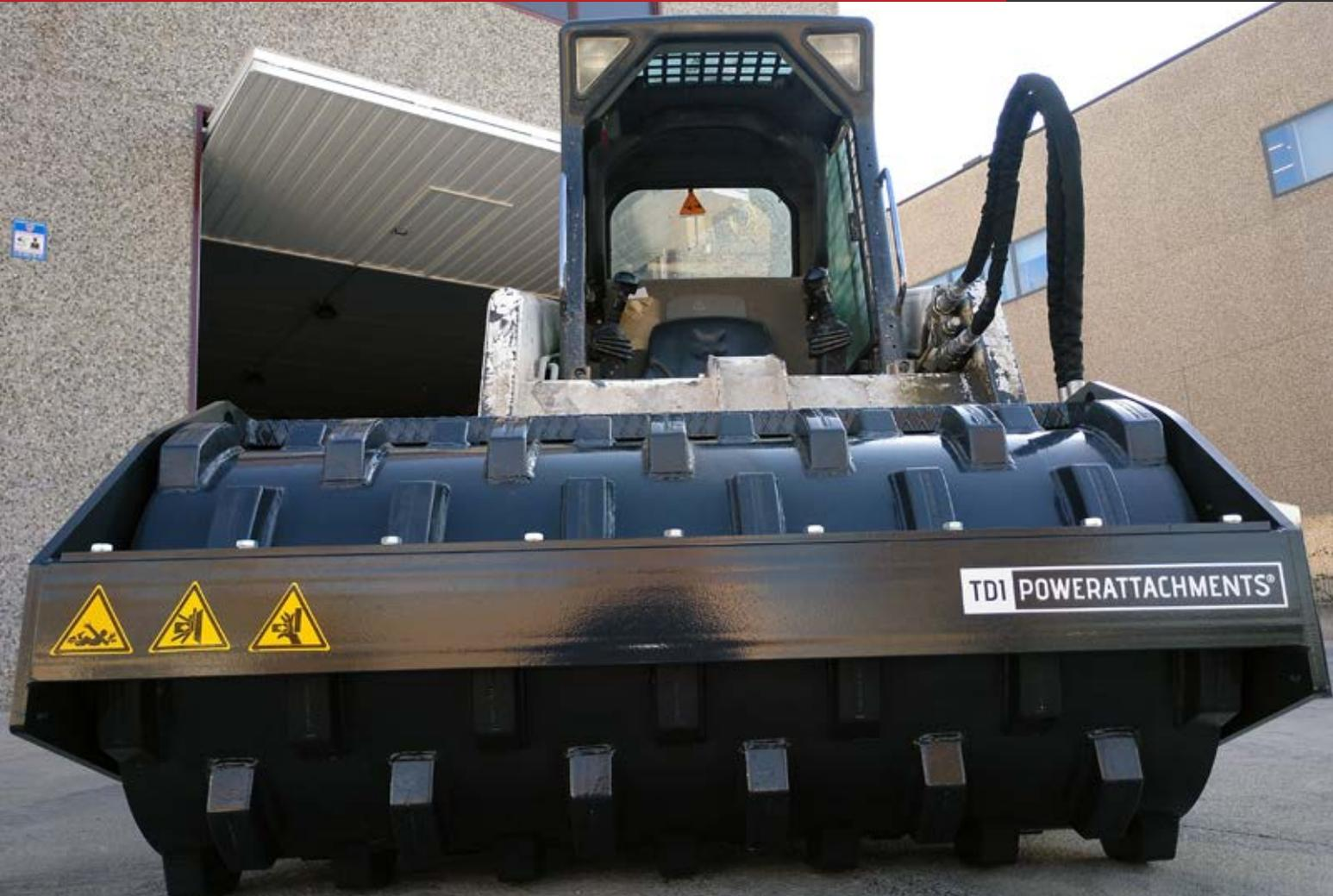
Compactador vibratorio con tambor pata de cabra de alto rendimiento y gran potencia, especialmente indicado para trabajar en terrenos arcillosos, plásticos, húmedos o muy duros y para el compactado de capas base, rellenos, etc.
